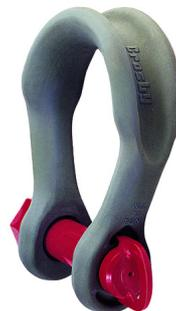
Größen mit einer Tragfähigkeit von 7 bis 300 Tonnen aus legiertem Schmiedestahl, ab 400 Tonnen aus legiertem Gussstahl. Durch die breitere Auflage und großen Radius im Schäkelbügel werden in Kombination mit Drahtseilen und PES Anschlagmitteln höhere Tragfähigkeiten und bessere Standzeiten der Anschlagmittel erreicht. Prüflast: 200 % (größer 300 t- 133 %) der Tragfähigkeit. Bruchlast: 500 % (größer 300 t – 450%) der Tragfähigkeit. Ab 30 t mit RFID Chip ausgestattet.
