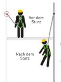
**Auffangsituation - Anschlagpunkt** befindet sich in **Fußhöhe** des Anwenders
