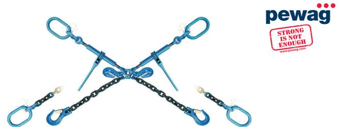
Absetzmuldensicherung im Diagonalzurrverfahren (X-Zurrung), optimale und gesetzeskonforme Sicherungsvariante nach VDI 2700 (Blatt 17) und EN 12195-2, doppelte Diagonalverzerrung für sehr schwere Behälter, Verstellung durch Verkürzungshaken, Güteklasse 12 Qualität. Die Zurrkette besteht aus Ösenhaken, Aufhängering als Endring, hochfester Kette, Verkürzungseinheit mit Sicherung und einem Ratschlastspanner mit Ausdrehsicherung.
