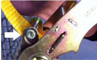
Die Gurtbandführung der ERGO Langhebel Zugratschen beachten, das Gurtband wird hinter dem Führungssteg, der gestempelte Pfeil auf der Ratsche zeigt die Gurtbandposition, in die Wickelwelle eingeführt.
