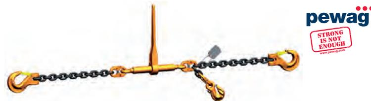
Zurrkette nach EN 12195-3 zur Schwerlastverzurrung. Fest montierte einteilige Zurreinheit bestehend aus Kettenbauteilen in Güteklasse 10 Qualität. Die Zurrkette besteht aus Gabelkopfhaken, hochfester Kette, Verkürzungseinheit mit Sicherung und einem Ratschlastspanner mit Ausdrehsicherung.
