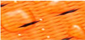
Imprägniertes Gurtband, Wasser abweisend
