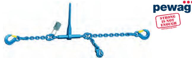
Zurrkette nach EN 12195-3 zur Schwerlastverzurrung. Fest montierte einteilige Zurreinheit bestehend aus Kettenbauteilen in Güteklasse 12 Qualität. Die Zurrkette besteht aus Ösenhaken, hochfester Kette, Verkürzungseinheit mit Sicherung und einem Ratschlastspanner mit Ausdrehsicherung.
