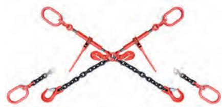
Absetzmuldensicherung im Diagonalzurrverfahren (X-Zurrung), optimale und gesetzeskonforme Sicherungsvariante nach VDI 2700 (Blatt 17) und EN 12195-2, doppelte Diagonalverzerrung für sehr schwere Behälter, Verstellung durch Verkürzungshaken, Güteklasse 8 Qualität. Die Zurrkette besteht aus Gabelkopfhaken, Aufhängering als Endring, hochfester Kette, Verkürzungseinheit mit Sicherung und einem Ratschlastspanner mit Ausdrehsicherung.
