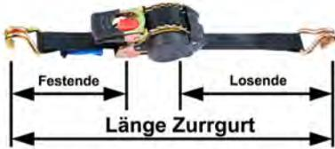
Ausführung: ähnlich EN 12195-2, mit automatischer Gurtaufrollung, GS-Zeichen, beidseitig mit Spitzhaken verzinkt, Farbe: schwarz, Länge Festende: 0,35 Meter (Standard), Länge Losende: 2,65 Meter für Gesamtlänge: 3,0 Meter.
