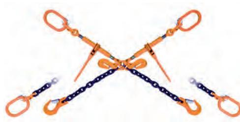
Absetzmuldensicherung im Diagonalzurrverfahren (X-Zurrung), optimale und gesetzeskonforme Sicherungsvariante nach VDI 2700 (Blatt 17) und EN 12195-2, doppelte Diagonalverzerrung für sehr schwere Behälter, Verstellung durch Verkürzungshaken, Güteklasse 10 Qualität. Die Zurrkette besteht aus Gabelkopfhaken, Aufhängering als Endring, hochfester Kette, Verkürzungseinheit mit Sicherung und einem Ratschlastspanner mit Ausdrehsicherung.
